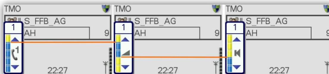
Bei mehreren Bediengeräten kann die Hörerlautstärke nur an der jeweiligen Bedienstelle angepasst werden, die Lautstärke externer Lautsprecher jedoch an allen Bedienteilen.
